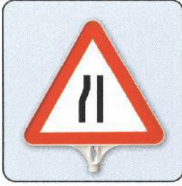
134 A R Soldan Daralan Kaplama
