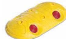
12006 Oval Yol Butonu Ölçüler : (LxWxh) 120x220x28 mm Malzeme : PPC Renk : Kırmızı , Siyah Ağırlık : 0.21 kg Özellik : Reflektif Mercek Montaj : 6x105 mm Burgulu Çivi
